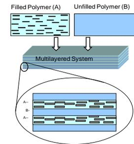
Низкая газопроницаемость с использованием коммерчески доступных материалов для упаковки и изоляции
