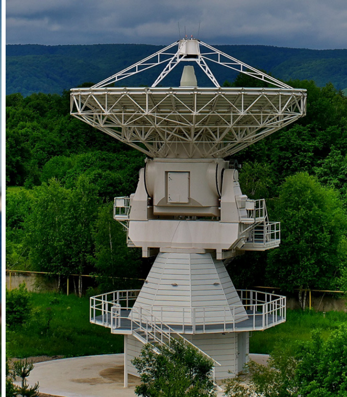
РТ-13 ИПА РАН (3 шт.) СКО \sim 0.06 мм VERTEX ANTENNENTECHNIK GmbH
