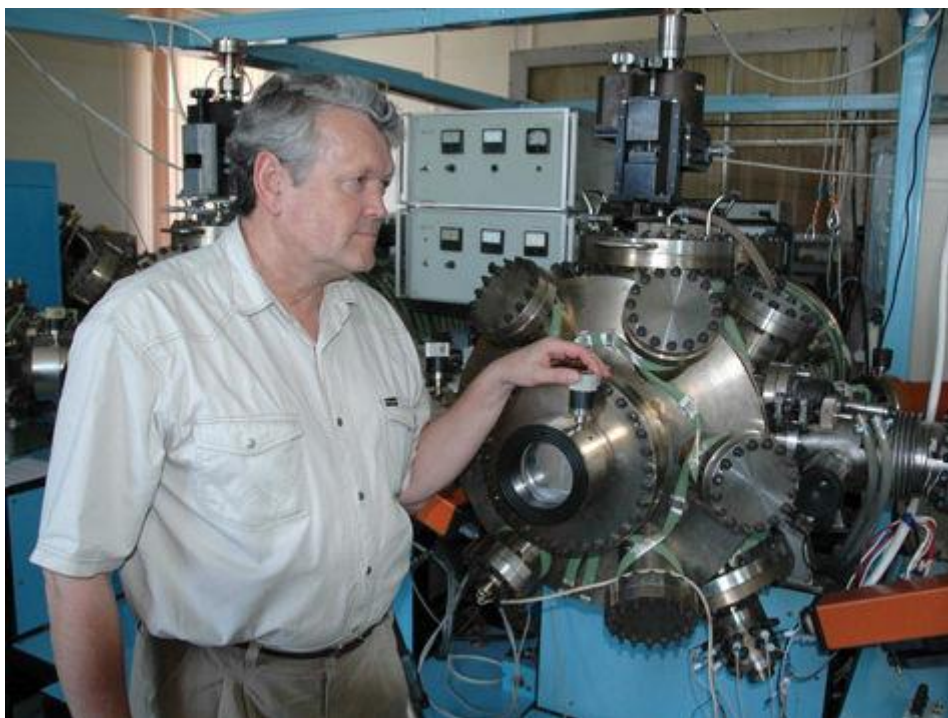
Вице-президент РАН, академик Александр Асеев возле сверхвысоковакуумной установки для выращивания полупроводниковых слоев. Фото: Портал научная Россия
