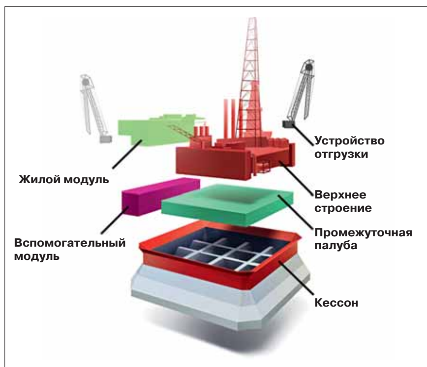
Конструкция ледостойкой стационарной платформы «Приразломная».
