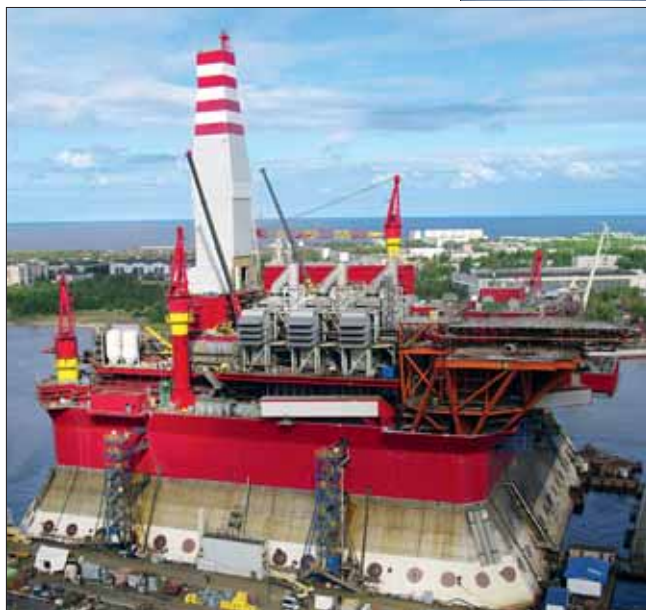
Достройка ледостойкой платформы «Приразломная» у набережной «Севмаша». 2010 г.
