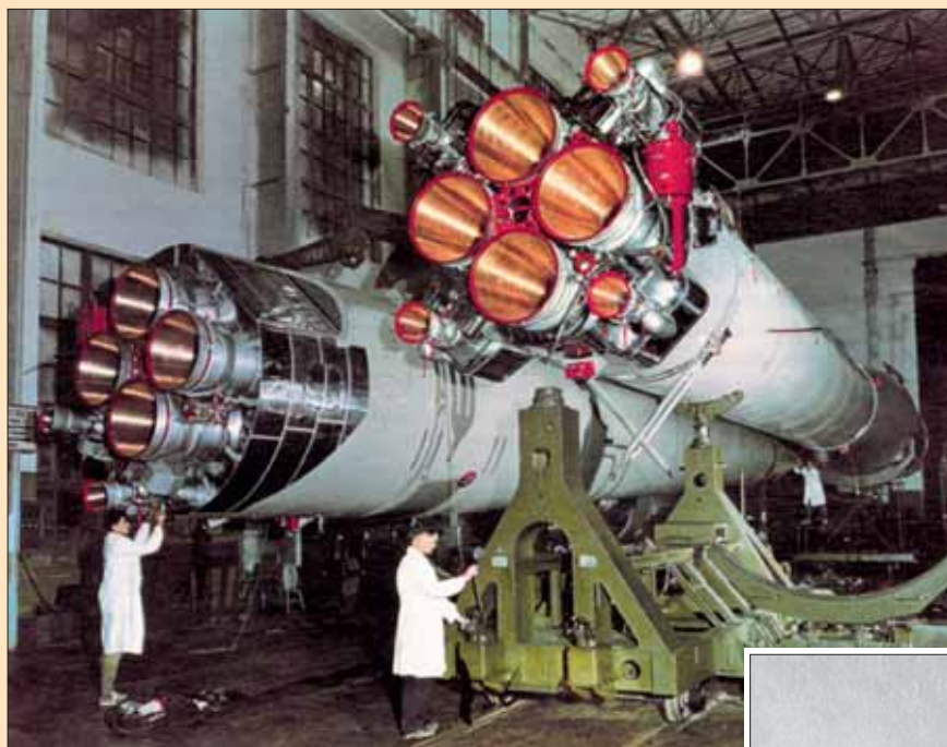
Сборка первой в мире межконтинентальной баллистической ракеты Р-7 в монтажно-испытательном корпусе конструкторского бюро. Фото из книги В.П. Порошкова «Ракетно-космический подвиг Байконура».
