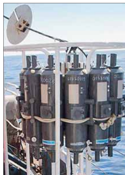
Прибор для отбора проб воды на различных глубинах.
