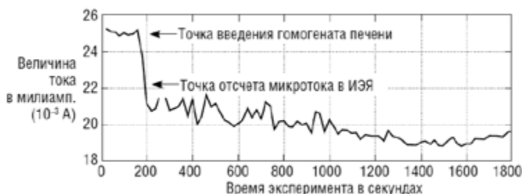
Рис. 14. Запись тока в ячейке электролизёра после добавления гомогената печени
