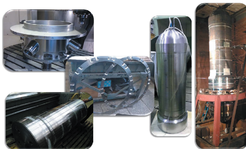
Рис. 5. Полномасштабный макет корпуса реактора
