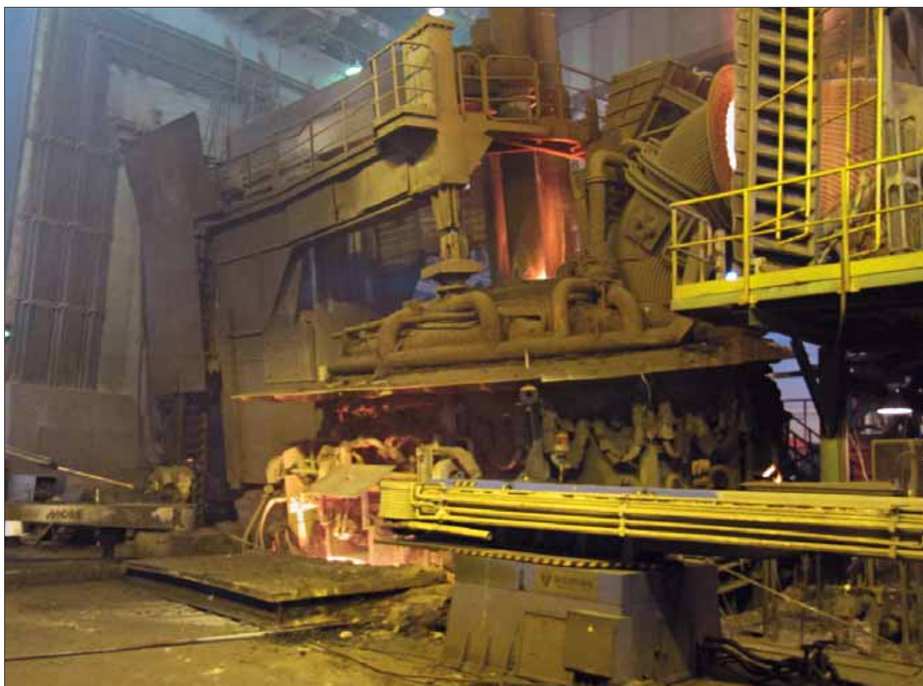
Современная электродуговая сталеплавильная печь, в которой осуществляется переплав стального лома — полный рециклинг важнейшего конструкционного материала.
