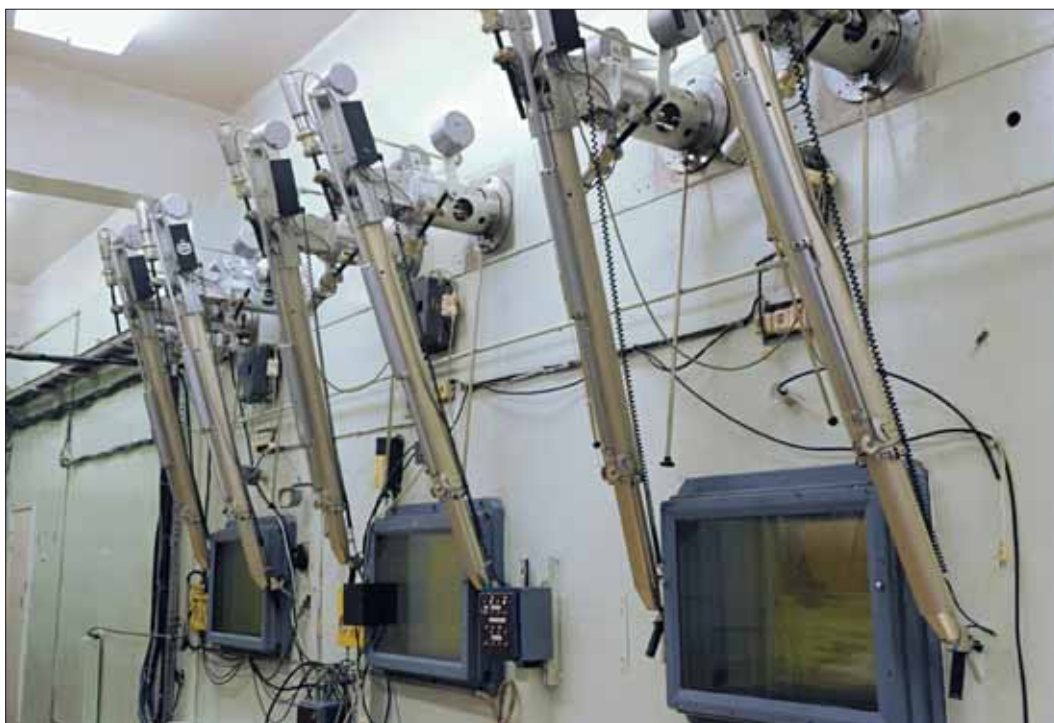
«Горячие» камеры для испытания и исследования топлива для атомных электростанций в НИИ атомных реакторов (г. Димитровград Ульяновской области). Фото С. Гунеева
