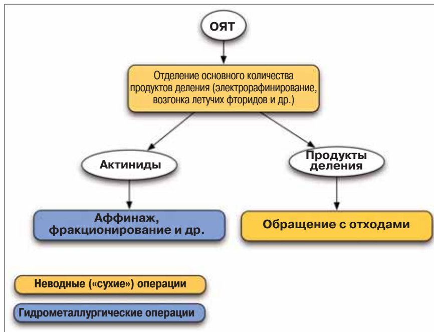
Принципиальная схема головных операций комбинированных технологий для переработки низковыдержанного облученного ядерного топлива.
