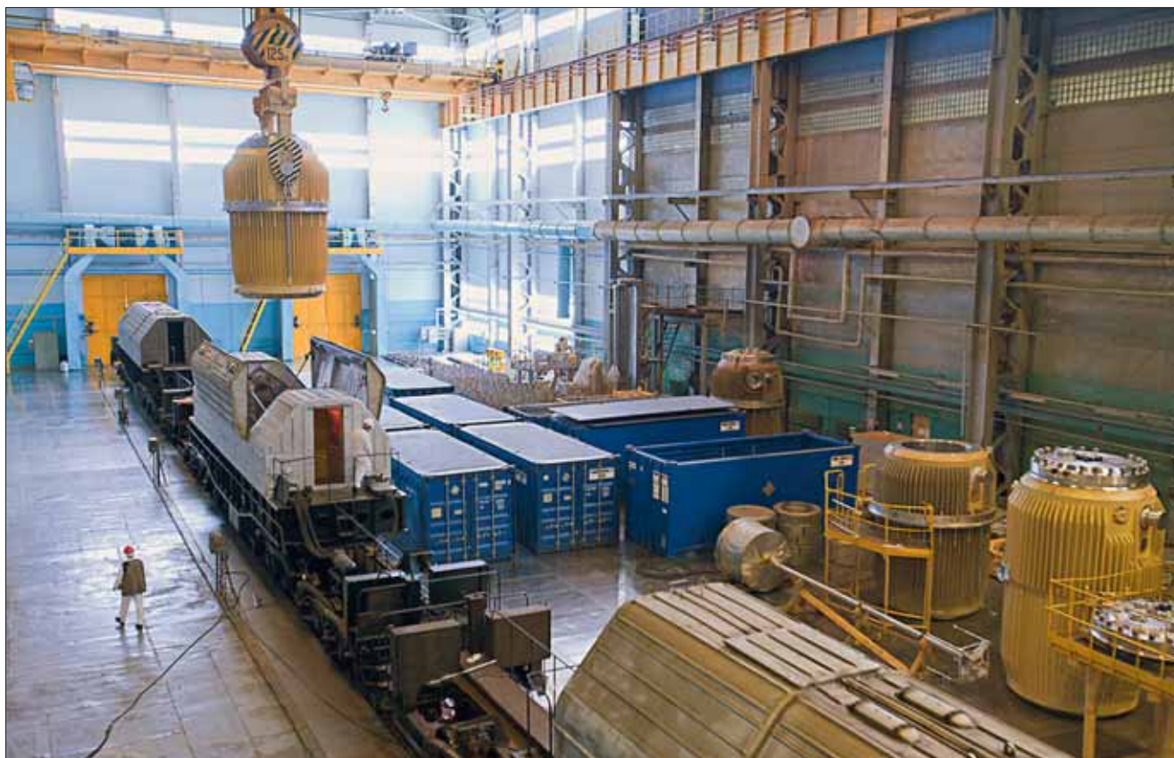
Завод по регенерации облученного ядерного топлива РТ-1, введенный в эксплуатацию в 1977 г. на Производственном объединении «Маяк» (г. Озерск Челябинской области). Фото И. Яковлева
