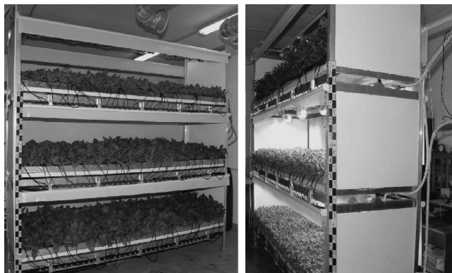
Рис. 1. Крупногабаритный автоматизированный вегетационно-облучательный модуль для выращивания растений
