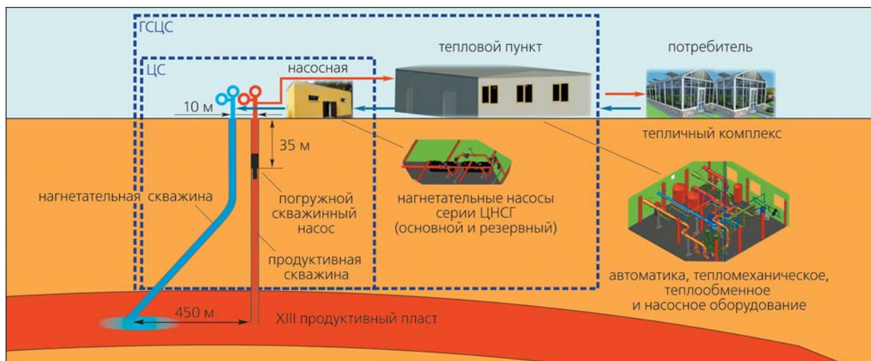
Рис.6. Схематический рисунок Ханкальской геотермальной циркуляционной системы отбора глубинного тепла Земли [15].
