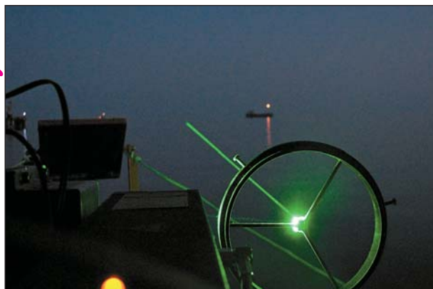
Лазерное дистанционное зондирование с помощью компактного лидара.
