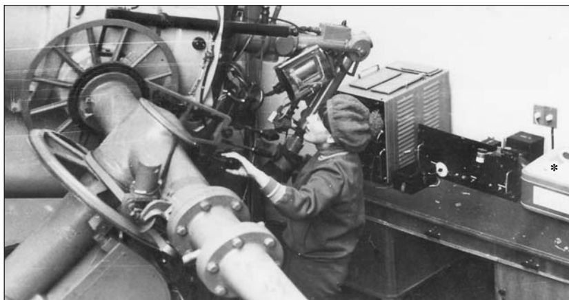
Рис.7. Один из авторов статьи за рефлектором, оснащенным сканирующим дифракционным спектрометром конструкции А.В.Харитоновой. Результаты наблюдений записывались на магнитную ленту (*) и обрабатывались на ЭВМ. Алма-Ата, 1969 г.
