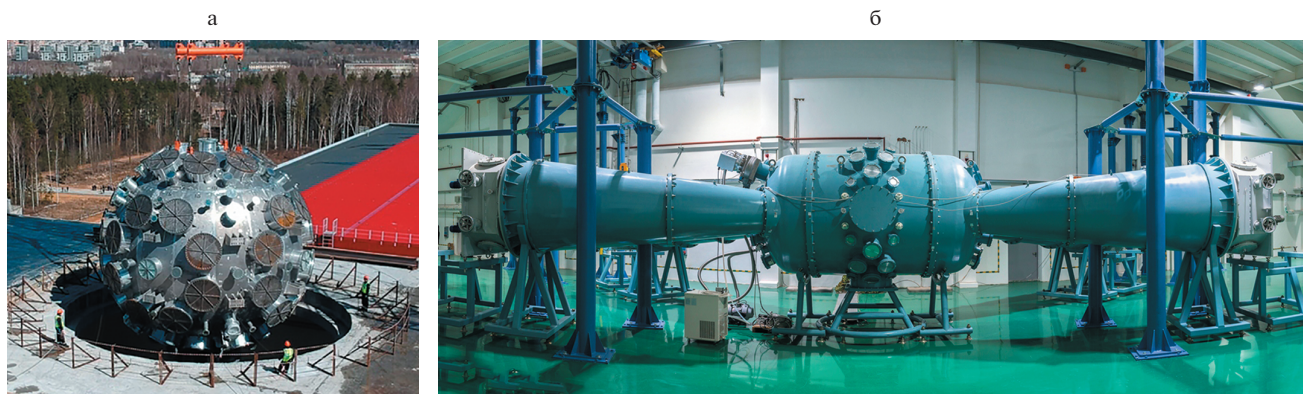
Рис. 6. Монтаж сферической вакуумной камеры диаметром 10 м (а), многофункциональная камера МИК (б)
