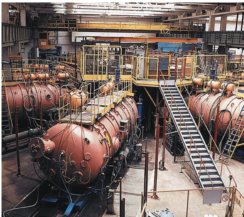
Рис. 6. Импульсный генератор “Ангара-5”, ГНЦ РФ Троицкий институт инновационных и термоядерных исследований госкорпорации “Росатом”
