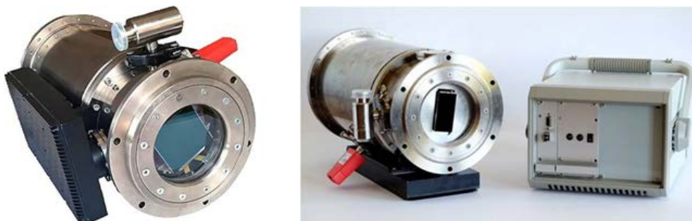
Рис. 34. Внешний вид ПЗС-систем: слева – на базе CCD231-84, справа – на базе CCD261-84
