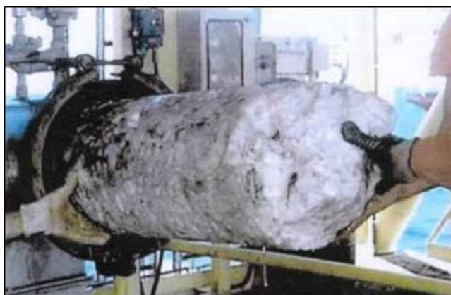
Рис. 52. Газогидратная пробка в трубопроводе
