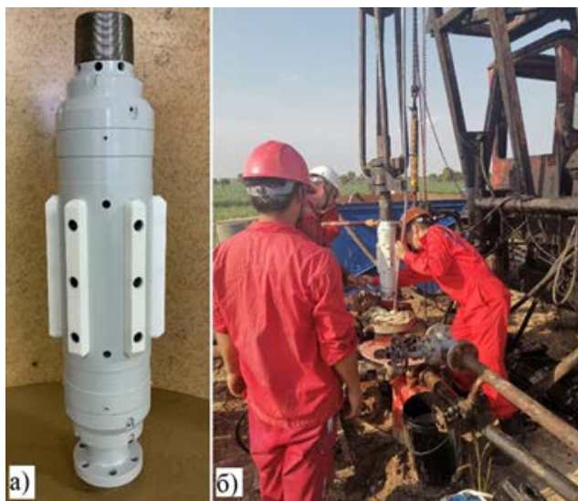
Рис. 65. а). Внешний вид генератора дебалансного типа; б) Шеф-монтаж скоростного дебалансного виброисточника в нефтяной нагнетательной скважине, компания «Синь Итун»
