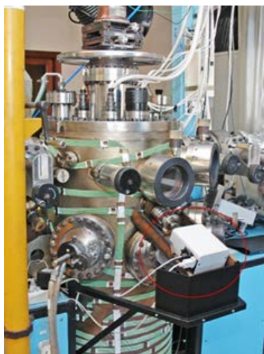
Рис. 21. Спектральный термоэллипсометрический комплекс, установленный на установке МЛЭ КРТ «Обь-М»
