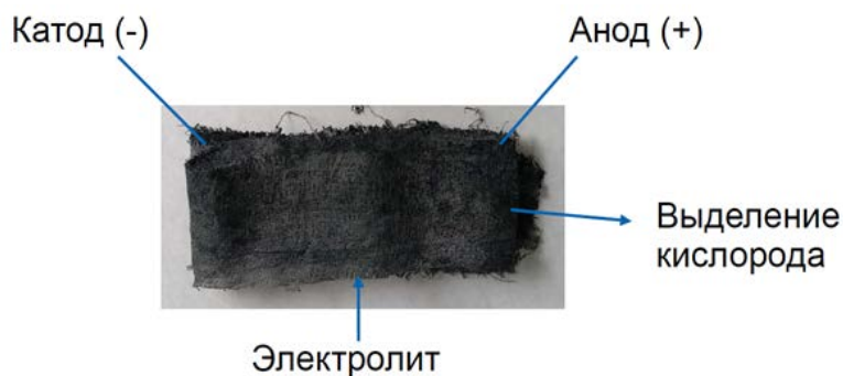
Рис. 53. Электроно- и ионопроводящая хлопковая ткань типа марли, волокна которой инкапсулированы слоями активного угля
