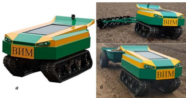
Рис. 139. Универсальное малогабаритное роботизированное транспортно-технологическое средство, а – общий вид, б – обработка почвы и транспортные работы
