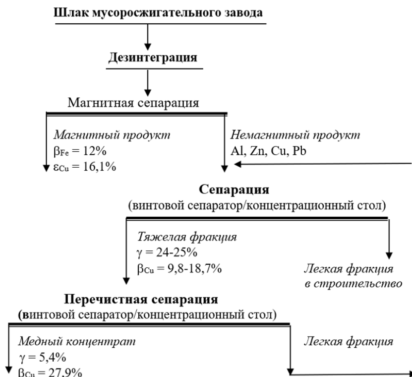
Рис. 102. Схема переработки шлаков мусоросжигающих заводов
