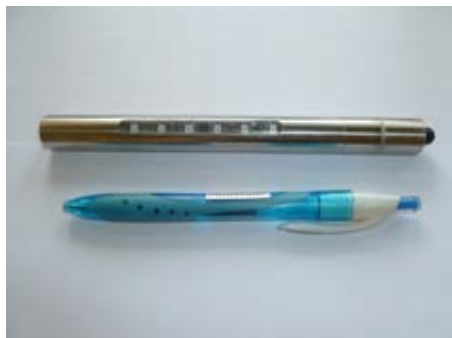
Рис. 26. Общий вид гамма-локатора (вверху) в сравнении с авторучкой (внизу)
