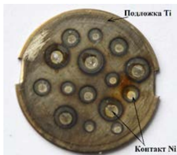
Рис. 36. Экспериментальная ячейка ТЭГа в виде «сэндвича»
