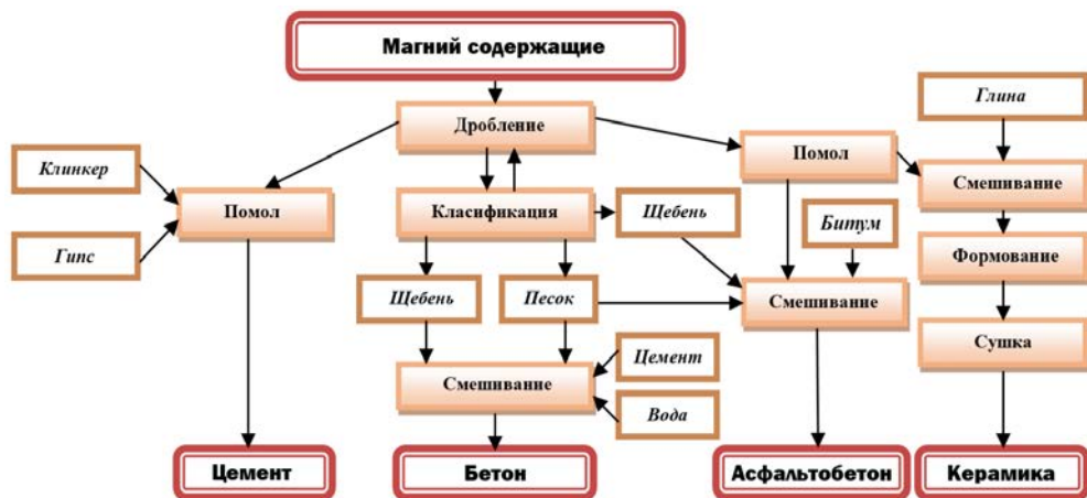
Рис. 74. Принципиальная технологическая схема переработки магнийсодержащих пород
