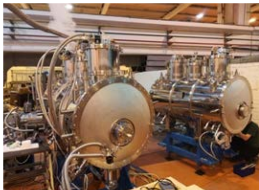
Рис. 30. Сверхпроводящие 54-полюсные вигглеры с полем 3.5 Тл и периодом 48 мм, работающие на принципе косвенного охлаждения, во время приёмочных испытаний
