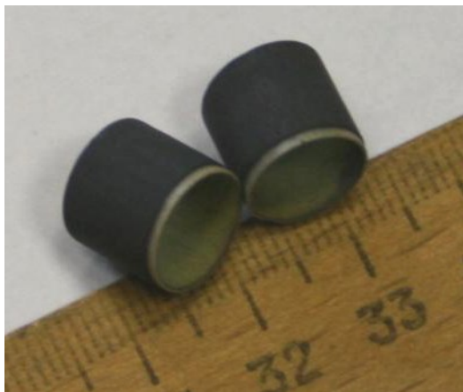
Рис. 1. Единичные топливные элементы с кислородными (снаружи) и топливными (внутри) электродами
