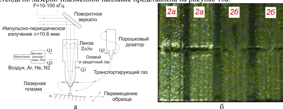
Рис. 10 Схема (а) экспериментального стенда по лазерно-плазменной наплавке и внешний вид (б) наплавленных дорожек, где 2а– NiCrBSi с оплавлением поверхности, 2б– NiCrBSi без оплавления поверхности
