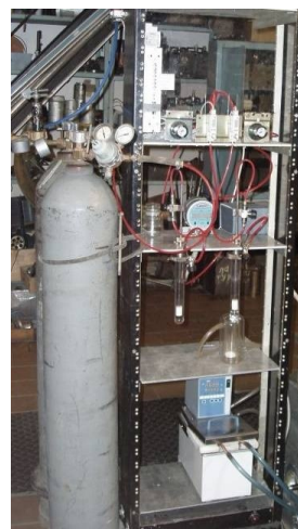
Рис. 4. Двухканальная система подачи реагентов плазмохимического синтеза.
