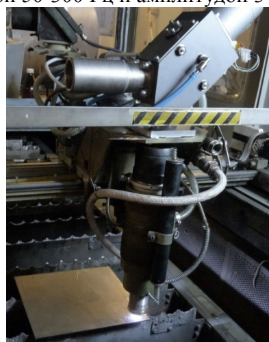
Рис. 6. Лазерно-плазменная обработка металла со сканированием на координатном столе.
