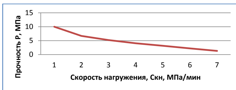
Рис. 3 Зависимость прочности льда (Р) от скорости нагружения (Скн.)
