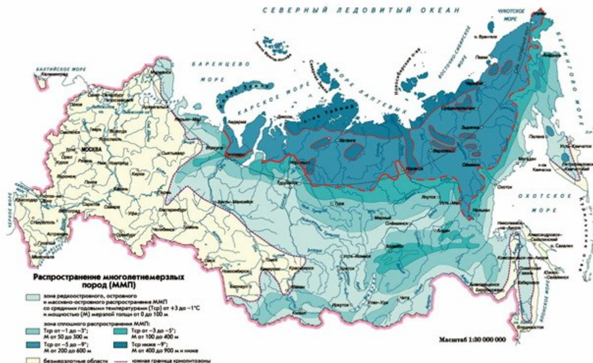
Рис.2 Распространение многолетнемерзлых пород (ММП)
