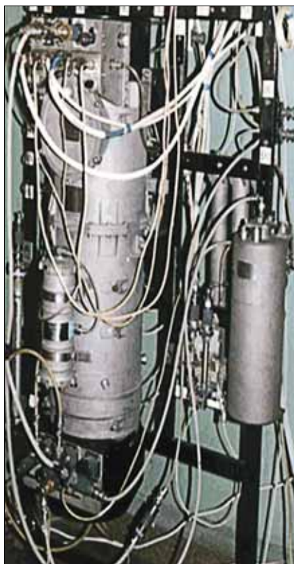
Система переработки углекислого газа СПУГ-В. Масса 55 кг, количество перерабатываемых газов: СО 2 — 160 л/ч, Н 2 — до 320 л/ч, среднесуточное энергопотребление 4 Вт на трех космонавтов.
