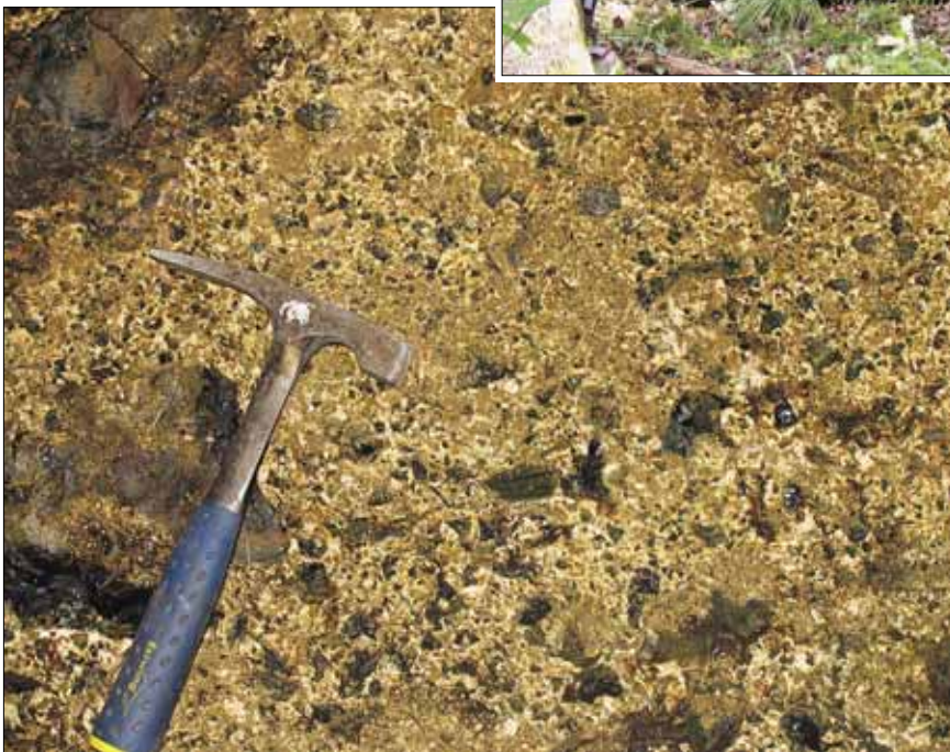
Гиалокластит состоит из обломков вулканического стекла, заключенных в основную массу, сложенную палагонитом.
