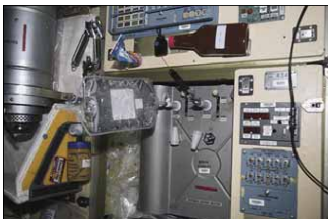
Система регенерации воды из конденсата атмосферной влаги CPB-K. Масса 115 кг, среднесуточное энергопотребление на одного космонавта 10 Вт.
