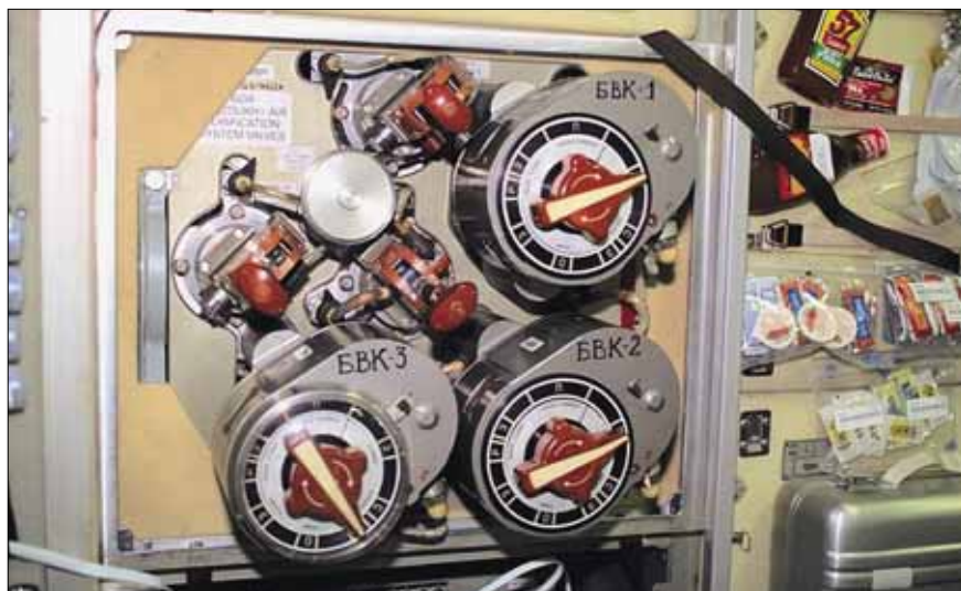
Система очистки атмосферы от углекислого газа «Воздух». Расход воздуха 10–27 м 3 /ч, среднесуточное энергопотребление 280 Вт на трех космонавтов.
