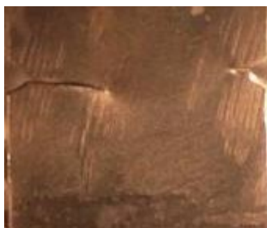
Рис. 8. Усталостная трещина в сварном соединении, образовавшаяся при испытаниях при температуре испытаний -40°С.
