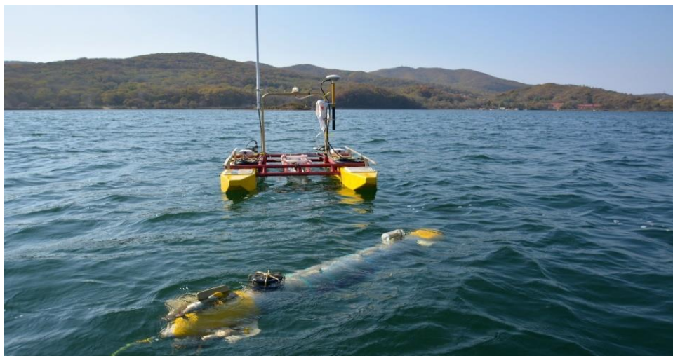
Рис. 2. АНПА и АНВА МАРК во время выполнения описанного эксперимента
