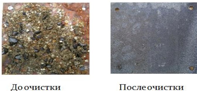
Рис. 4. Пример лазерной подводной очистки металлической поверхности от биологического обрастания
