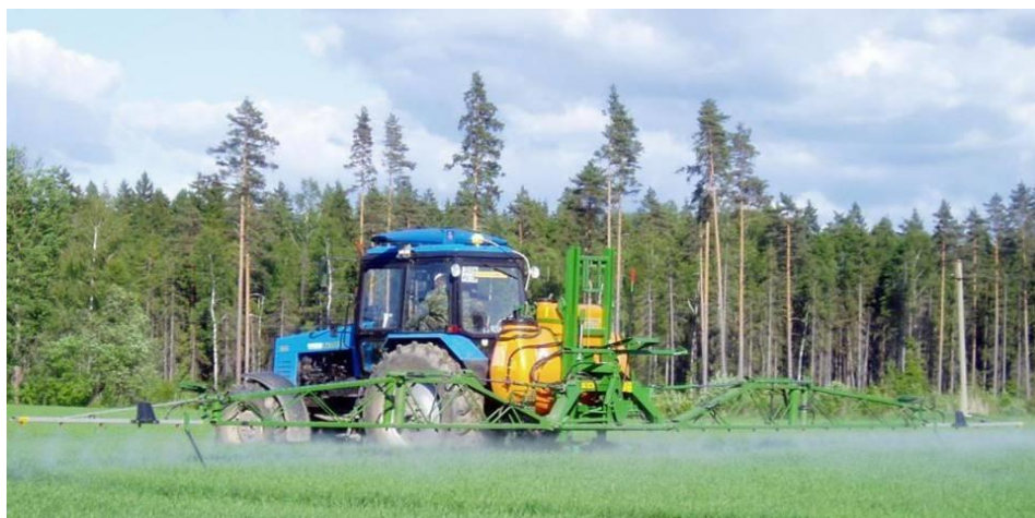
Рис. 3. Азотная подкормка посевов на полигоне АФИ с помощью N-сенсора (режим on-line)
