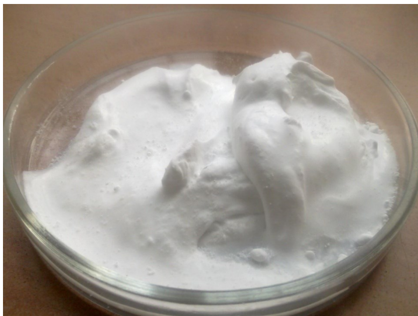
Рис. 7. Дисперсия 5 % водного раствора ПВС, стабилизированного гидрофобным аэросилом. Содержание аэросила 5 мас. %
