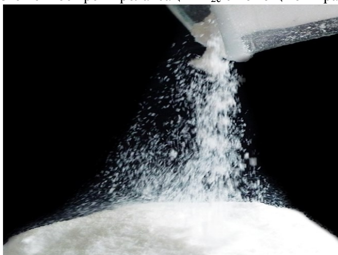
Рис. 1. «Сухая вода». Содержание аэросила 5 мас.%
