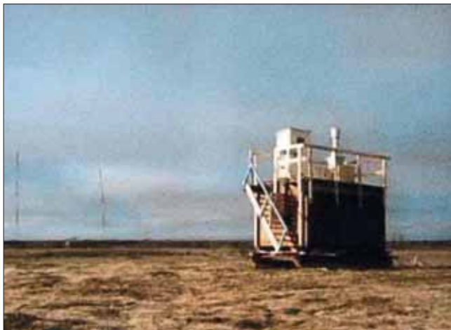
Станция непрерывного отбора проб атмосферного воздуха на содержание CO 2 в поселке Амдерма.
