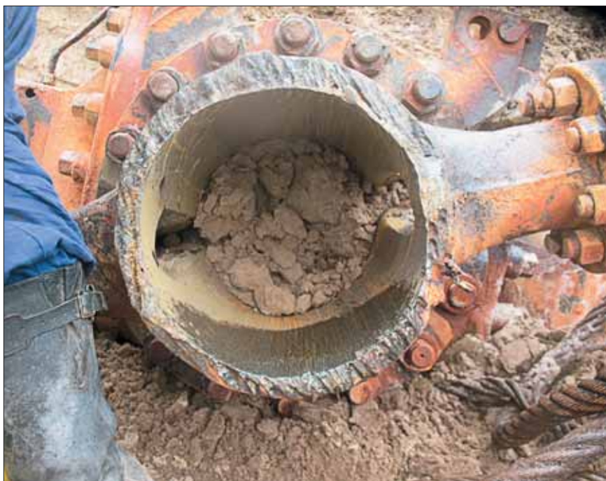
Толщина стенок срезанной лазером МЛТК-20 газовой детали изменяется от 30 до 40 мм.
