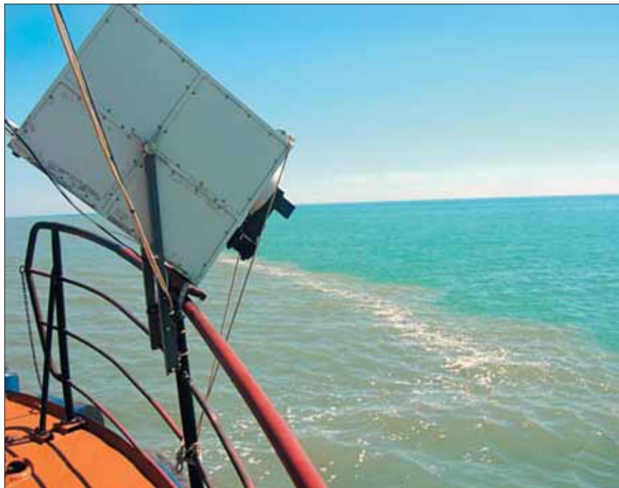
Ультрафиолетовый флуоресцентный лидар измеряет загрязнение в морской акватории города Сочи.
