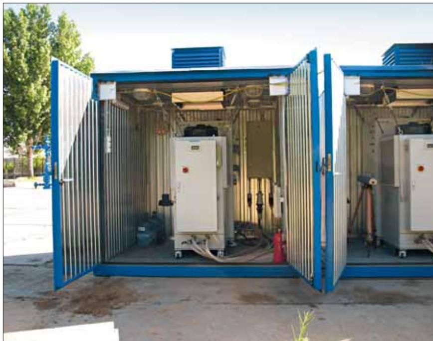
В трех контейнерах технологического комплекса МЛТК-20 размещены источники непрерывного волоконного лазерного излучения.
