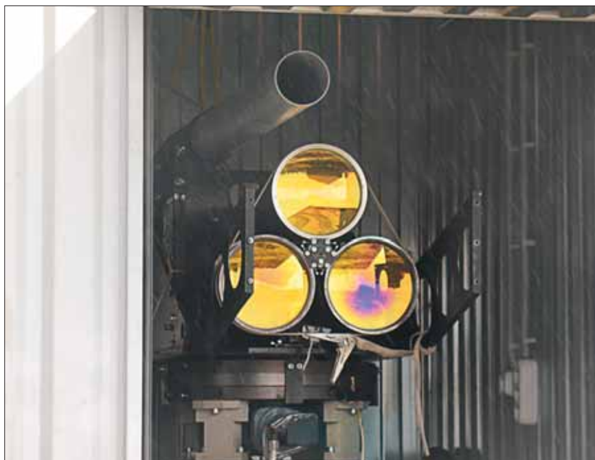
В четвертом контейнере находятся трехканальный телескоп с системами наведения лазерного луча на цель и управления комплексом, а также рабочее место оператора.
