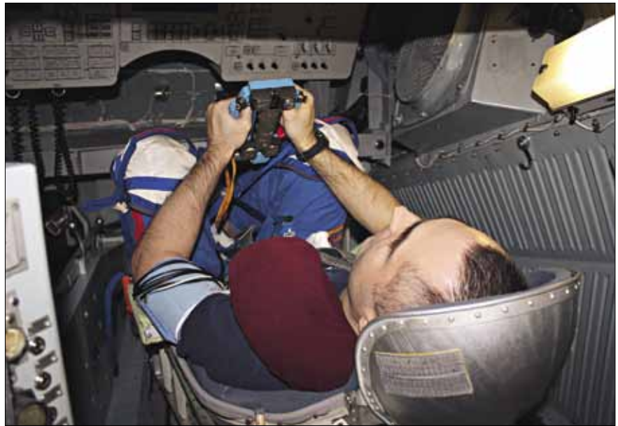
Выполнение космонавтом режимов ручного управления спуском в кабине ЦФ-18.
