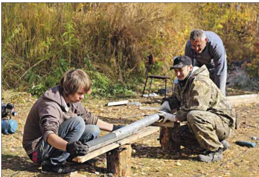
Очередной фрагмент керна сапропеля поднят, его готовят к герметичной упаковке.
