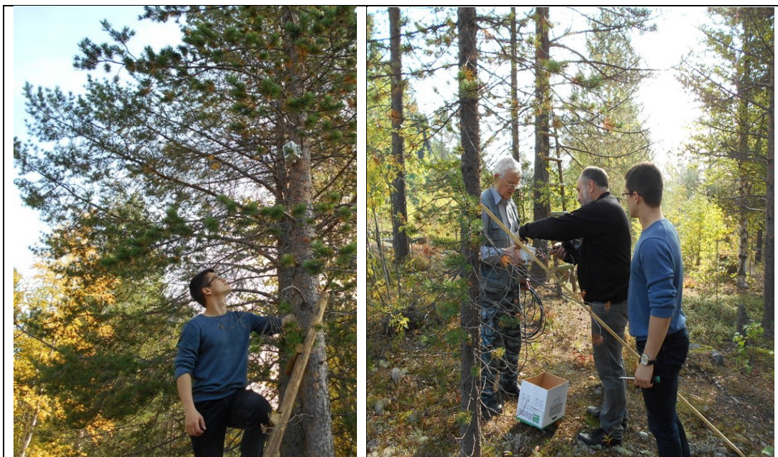
Рисунок 13. Испытания в сентябре 2014г. аппаратуры в районе восточных склонов Хибинского массива в лесу. Дальность между узлами связи составила около 300м. На левой фото крепление радиоузла на дереве. На правой фотографии Нивин Валентин держит в руках в сборе узел радиомодема и сенсора соединённого 5 м кабелем
