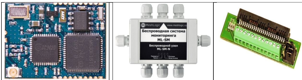
Рисунок. 7. Беспроводной типовой модуль ML-SM-N (справа) и устройство в сборе (центр), слева модуль сопряжения ML-SM-SVA
