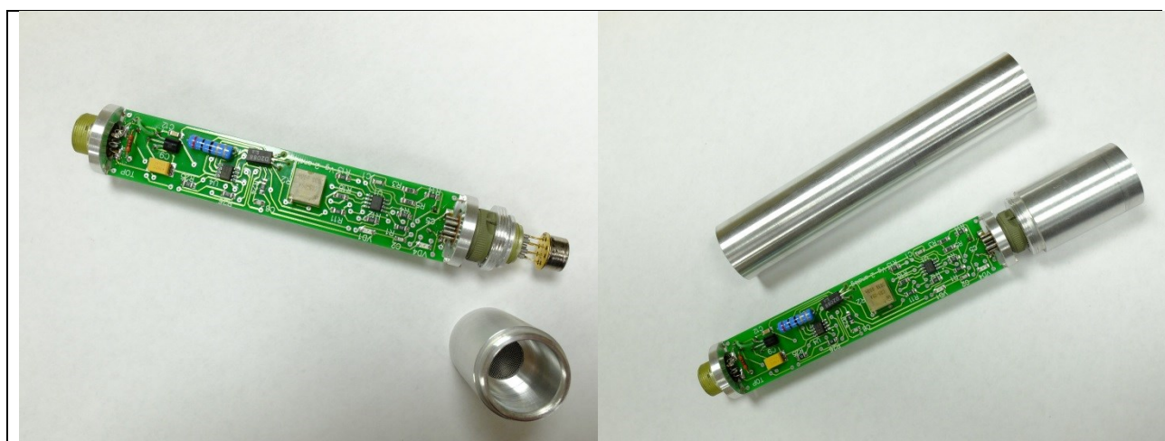
Рисунок 10. Сенсор в сборе, со снятым металлическим кожухом
