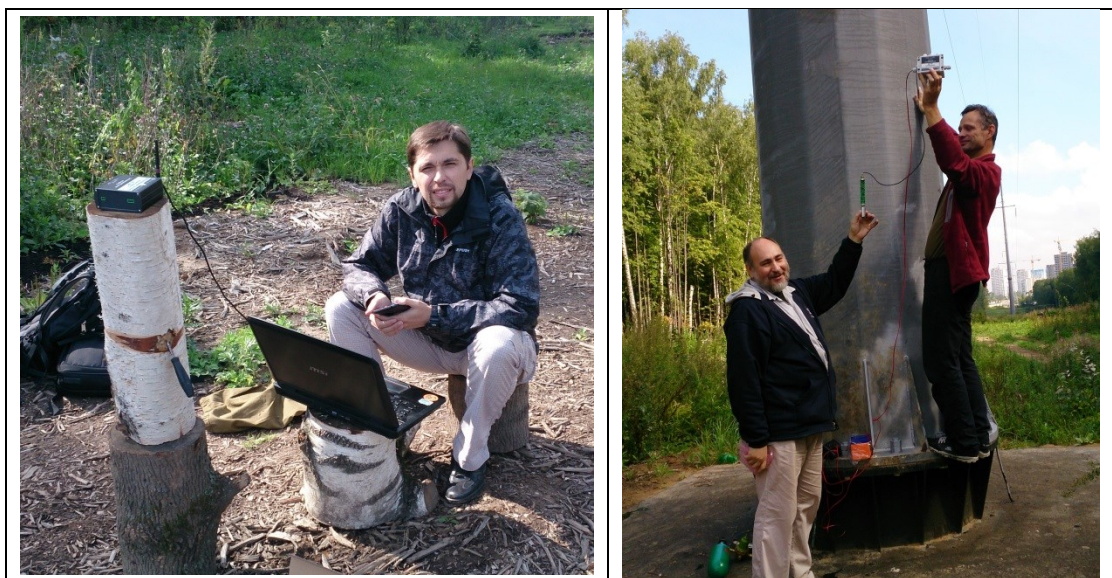
Рисунок 12. Первые испытания в августе 2014г. собранного комплекта аппаратуры в Москве в районе Битцевского лесопарка (измерения проводили вдоль линии ЛЭП, максимальная дальность около 600м). Слева Баскаков Сергей принимает сигнал с данными на сервере, справа Литвинов Артур и Асавин Алексей проводят измерения содержания H_2 с помощью искусственной смеси водорода из баллона (внизу зеленый) и воздуха.
