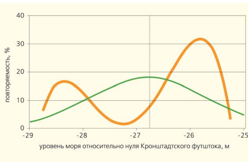
Рис.3. Сглаженная гистограмма распределения среднегодовых отметок уровня Каспийского моря с 1830 г. (оранжевая линия) в сравнении с графиком нормального распределения для той же выборки (зеленая линия).
