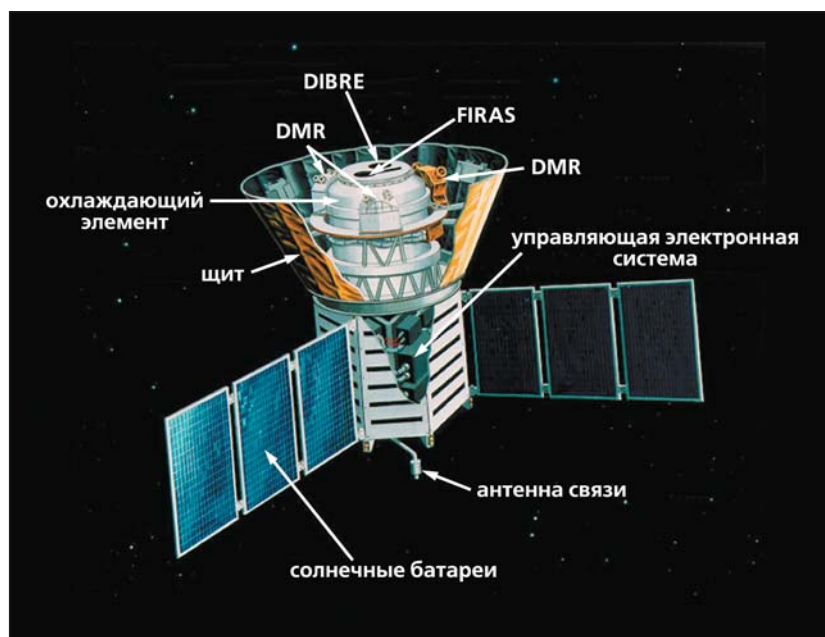
Рис.1. Спутник «COBE». Наверху за конусообразным щитом расположены приборы для изучения реликтового излучения (щит предназначался для защиты от постороннего излучения — излучения Земли, Солнца и т.п.). Приборы FIRAS и DIBRE находились внутри основной панели инструментов — в двух черных отверстиях. По окружности основной панели располагались три радиометра прибора DMR.
