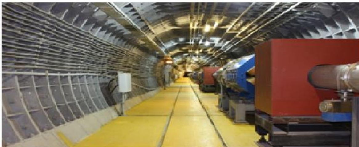
Канал формирования и транспортировки протонного пучка в составе ПРГК
