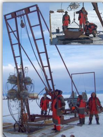
Рис. 7. Монтаж и запуск на озере Байкал базового структурного элемента создаваемого глубоководного нейтринного телескопа НТ1000
