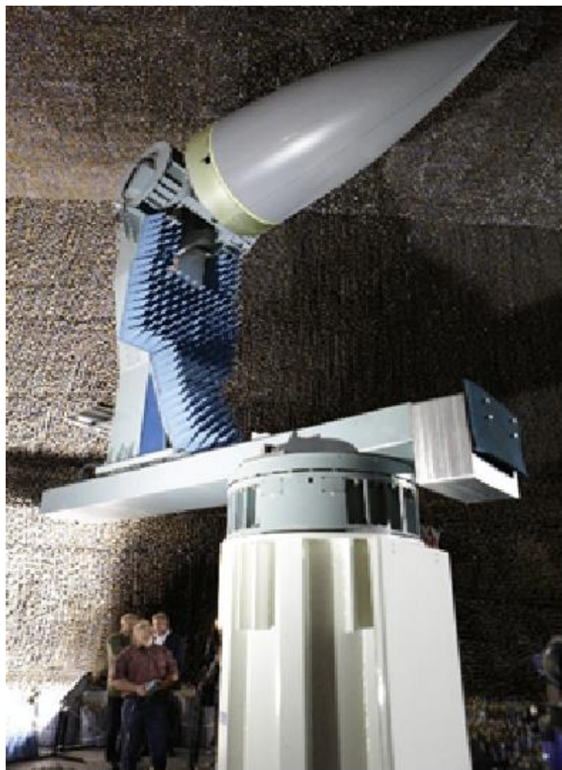
Исследование радиопоглощающих характеристик обтекателя на комплексе радиофизических измерений РАН
