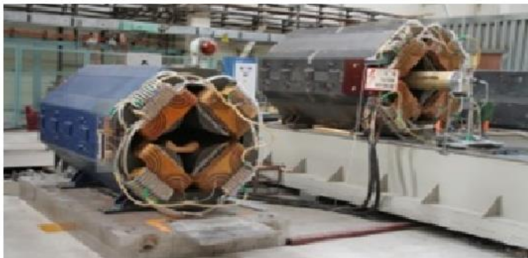
Квадрупольные линзы (апертура \varnothing 30 см, градиент 6.7 Тл/м) – основа магнитной оптики ПРГК
