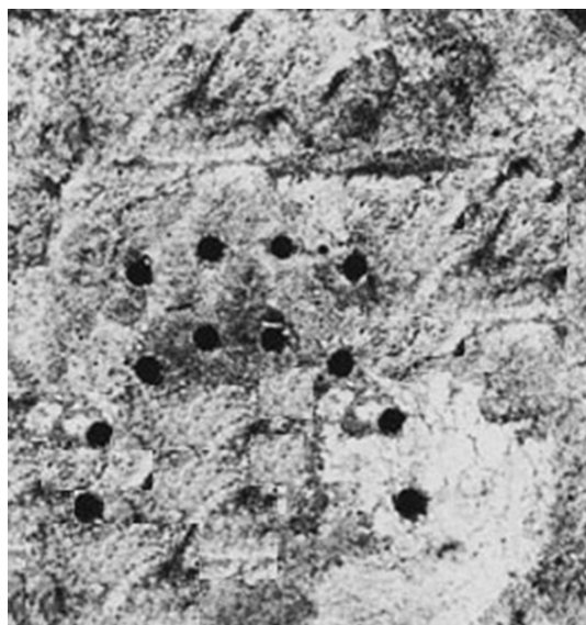
Рис. 3. Кумулятивная форма расположения сближенных зарядов во взрываемом блоке, формирующая направленную волну взрыва
