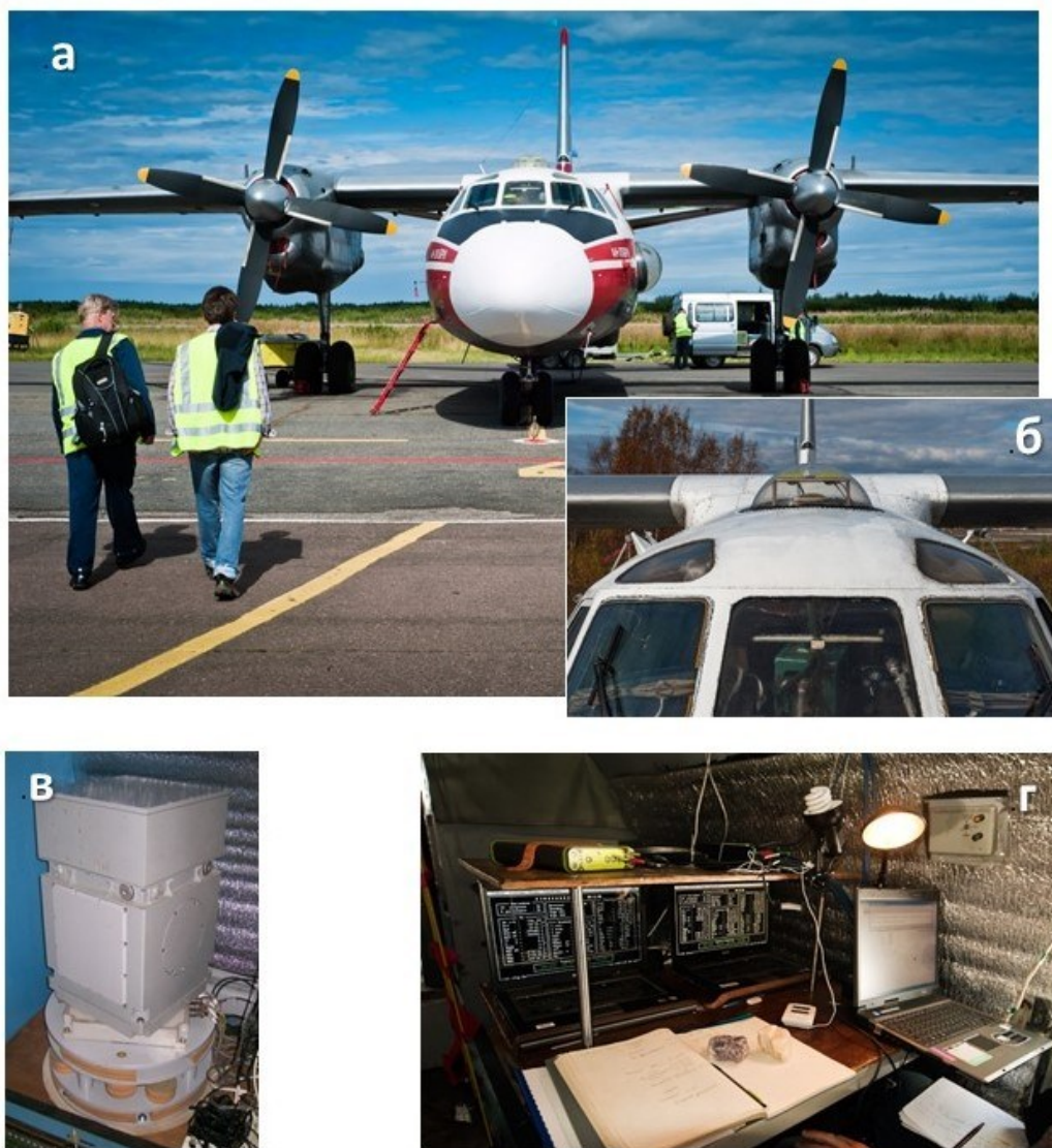
Рисунок 1 - Самолет-лаборатория ИФЗ РАН на базе АН-26 БРЛ: а) внешний вид, б) GPS-антенны в блистере над фюзеляжем самолета, в) внешний вид измерительного блока гравиметрического комплекса типа GT 1А/2А, г) рабочее место оператора на борту самолета-лаборатории.
