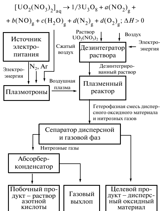
Рис. 1. Брутто-схема плазменного процесса разложения нитратных растворов урана на оксиды урана и азотную кислоту
