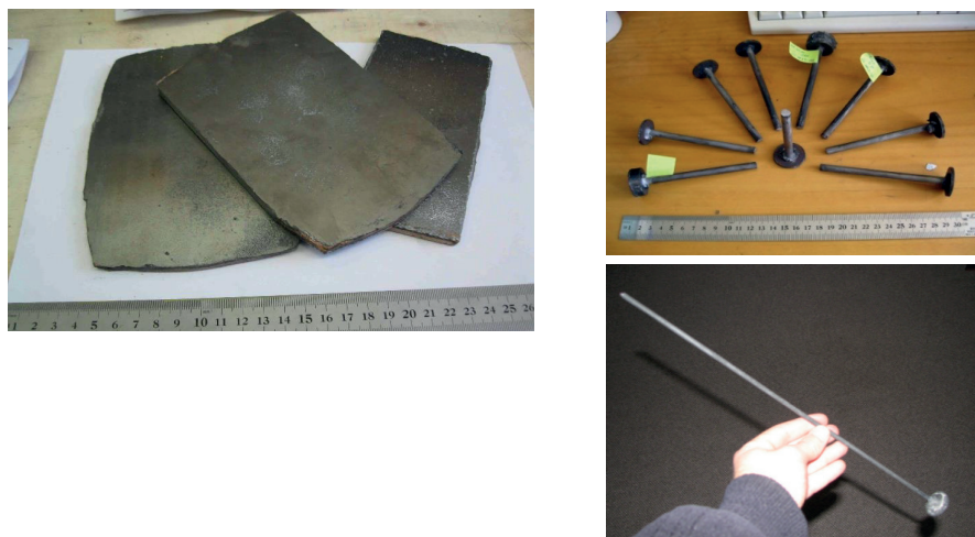
Рис. 12. Фото образцов: а - плиты, полученные методом свободного СВС-сжатия, б – электроды, полученные методом СВС-экструзии.
