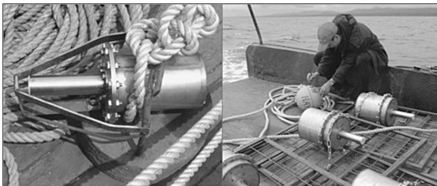
Рис. 1. Измерители длинных волн в открытом море (цунами и другие типы морских опасных явлений) – регистраторы придонного давления
